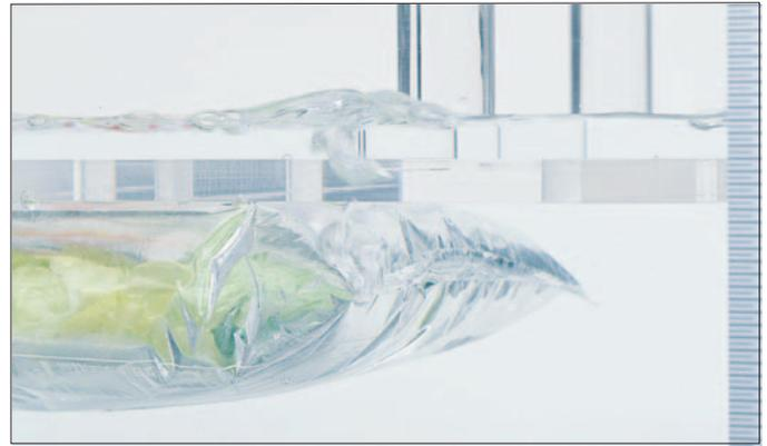
**Camara transparente del Pack-Vac permite una vision 360. Un chorro de burbujas identifica la fuga.**
